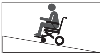
Maximale(s) Steigung/Gefälle: 9 Grad Maximales Personengewicht: 150 kg
